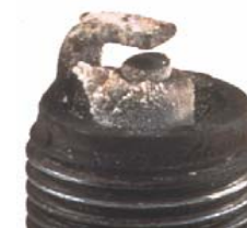
Отложения масла и охлажд. жидкости
