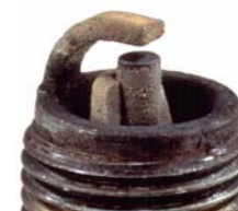
Разрушение изолятора
