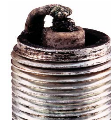
Калильное плавление
